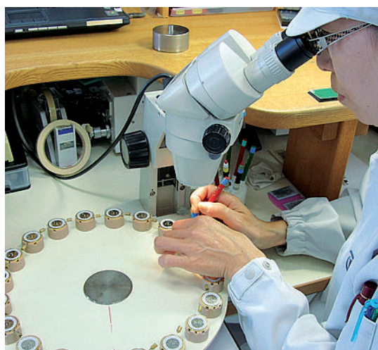
Al lavoro A sinistra, il carosello dei quadranti; al centro, si monta il bilanciere sull'ancora di scappamento; a destra, fase successiva di montaggio manuale delle lancette
