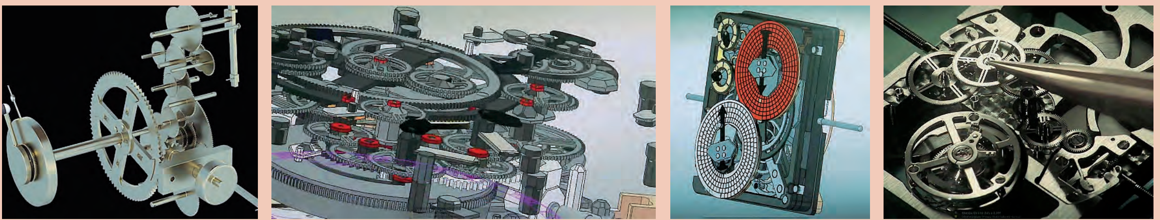
Fasi di studio Nelle prime tre foto da sinistra, la riproduzione al computer del meccanismo di Antikythera: queste elaborazioni sono servite per tracciare i disegni e le specifiche tecniche per realizzare il montaggio finale (ultima a destra). Hublot ha prodotto solo quattro movimenti, che si trovano al Musée des Arts et Métiers di Parigi, al Museo archeologico di Atene, nella sede svizzera di Hublot a disposizione dei mastri orologiai. L'ultimo verrà venduto all'asta a favore dello stesso Museo
