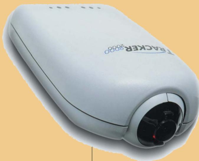
Sostitutivo del mouse, il tracker traduce i movimenti della testa in quelli del cursore. L'unità centrale wireless va posizionata di fronte all'utente, che deve applicare un punto adesivo rifrangente sulla sua stessa fronte o sulla montatura degli occhiali. Per il click, si usa un sensore a soffio fornito con il tracker. Lo produce Madentec ([www.madentec.com](http://www.madentec.com))
