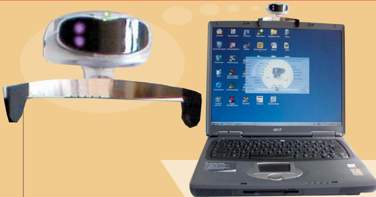
Smart-Nav è un sistema di "puntamento a testa", che ne controlla i movimenti tramite un piccolo adesivo (dots) posto sulla fronte o sugli occhiali dell'utente. Il suo punto di forza è nelle dimensioni decisamente contenute, che consentono di posizionarlo anche sullo schermo di un laptop. Le funzioni di click, doppio click e trascinamento sono automatiche. Lo produce l'americana Naturalpoint ([www.naturalpoint.com](http://www.naturalpoint.com))
