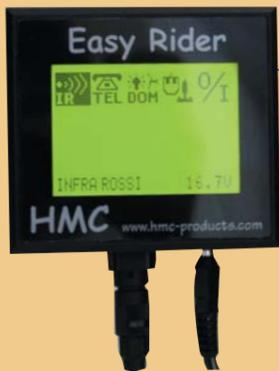
Easy Rider è un sistema di controllo unico per la gestione della carrozzina e del pc. Grazie a questo prodotto, il joystick della carrozzina diventa il mouse del computer. Quest'ultimo si può controllare completamente con uno speciale programma di emulazione. Lo produce Hmc ([www.hmc-products.com](http://www.hmc-products.com))
