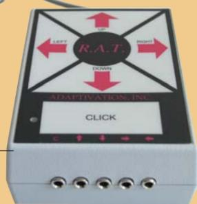
Rat, ovvero Rodent Activated by Touch. Il gioco di parole sottolinea la sua parentela con il mouse, di cui è un emulatore. Si installa senza software, con la sola connessione. Per la funzione «trascinamento» non si deve tener premuto alcun tasto: un led luminoso provvede a segnalare. [www.adaptivation.com](http://www.adaptivation.com)
